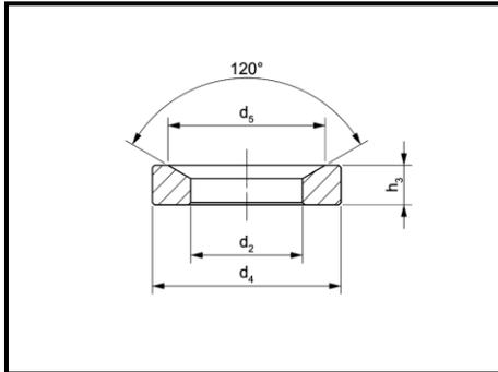
Aufgrund ihrer Abmessungen dürfen Kegelpfannen Form D nur bei Bohrungen, nicht bei Langlöchern verwendet werden.
