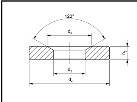
Kegelpfannen Form G eignen sich aufgrund ihrer stabileren Ausführung im Vergleich zu der Form D besonders für die Verwendung bei Langlöchern oder unebener Auflagefläche.
