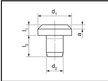
Auflagebolzen können als Anschläge, Auflagen, Füße und Druckstücke verwendet werden.
