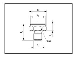
Positionsfüße können als Anschläge, Auflagen und Druckstücke verwendet werden.
