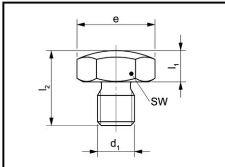
PositionsfüÙe können als Anschläge, Auflagen und Druckstücke verwendet werden.
